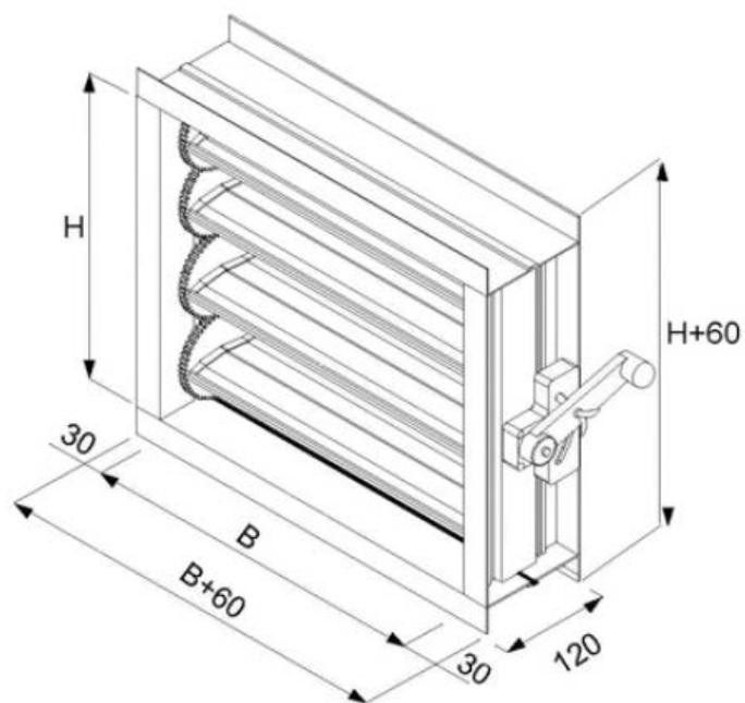
$H$  - высота рабочего сечения клапана     $B$  - длина рабочего сечения клапана
